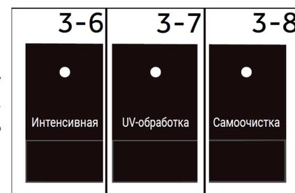
Функцию обработки ультрафиолетом можно выбрать в программах «Ежедневная» и «Объёмные вещи» и только в режиме ожидания. После запуска программы функцию «UV-обработка» нельзя отменить в течение периода ожидания.
